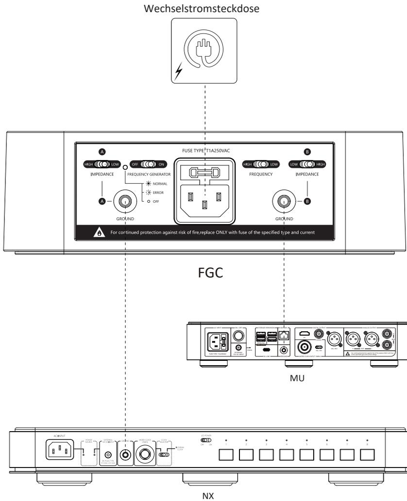
Hinweis: Diese Verbindung dient nur als Referenz. Sie können auch eine Verbindung zu Silent Angel FX, GX oder einen USB-Adapter verwenden.
